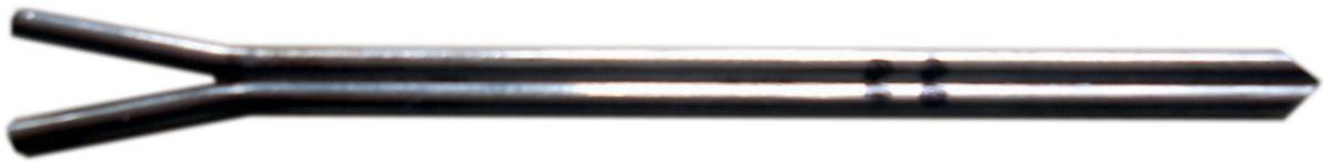
**Abbildung 48: Conrad-Sonde zur Ermittlung von Strömungswinkel und –geschwindigkeit**
