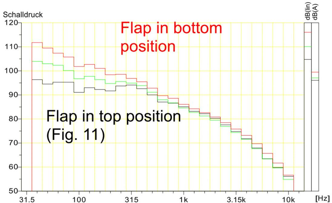
Abbildung 56: Schalldruckpegel für verschiedene FHK Positionen bei 20m/s und 10° Anstellwinkel
