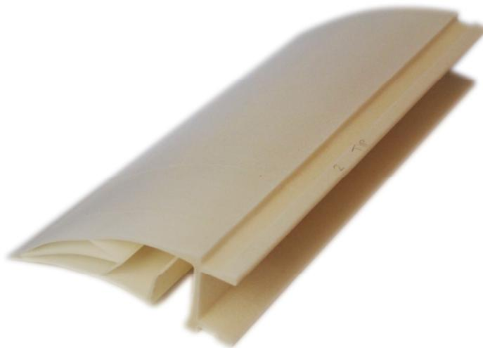
**Abbildung 64: Mittels SLS-Verfahren hergestelltes Hinterkantenelement**
