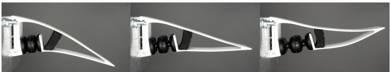
Abbildung 57: Neues Hinterkantenkonzept mit thermoplastischer Struktur und Balgaktuator
