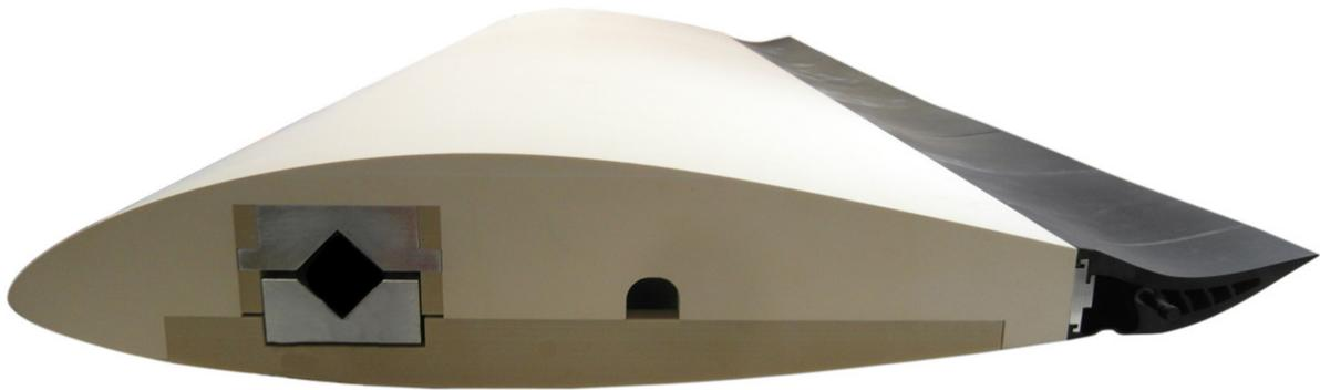
**Abbildung 38: Windkanalmodell aus Formbauwerkstoff mit flexibler Hinterkante**
