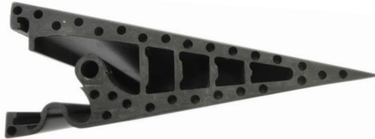
**Abbildung 31: Finale Hinterkante für die Untersuchungen am Windkanalmodell**
