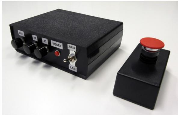
Abbildung 41: Steuerbox und Not-Aus-Schalter
