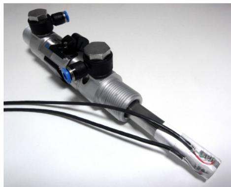
**Abbildung 36: Messzylinder zur Ermittlung von Zylinderposition und Aktuierungskräften**
