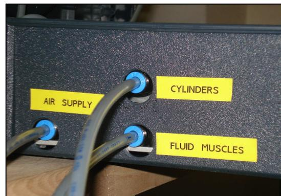
Abb. 89: Druckluftanschlüsse
