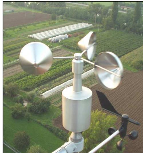
Abb. 10: Schalenkreuzanemometer [2]
