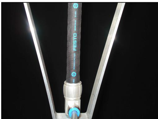
Abb. 34: Unbetätigter pneumatischer Muskel
