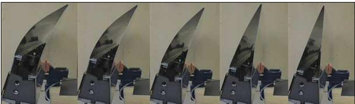
Abb. 90: Flexible Hinterkante in verschiedenen Stellungen
