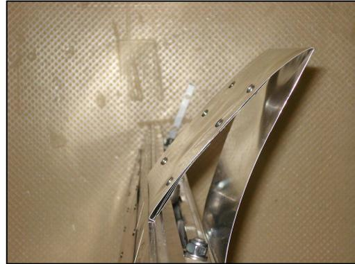
**Abb. 86: Hinterkante mit unterschiedlichen Wandstärken in Endposition**
