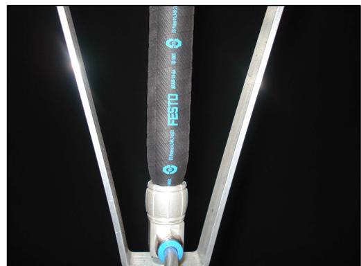
Abb. 35: Betätigter pneumatischer Muskel bei der Maximalkontraktion
